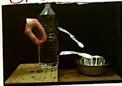
شکل ۳-۱۲ با باز کردن در بطری، آب از سوراخ‌های ایجاد شده در بطری، با فشار متفاوت خارج می‌شود. سرعت خروج آب از کدام سوراخ بیشتر است؟
