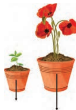
شکل ۲-۲ گاهی برای سادگی فرض می‌شود که همه جرم یک جسم در یک نقطه به نام مرکز جرم جسم متمرکز شده است و به‌جای آنکه نیرو به قسمت‌های مختلف جسم وارد شود به این نقطه وارد می‌شود.
