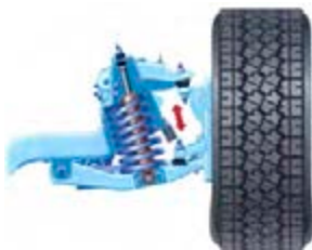
شکل ۲-۱۴ فنرهای به کار رفته در چرخ‌های خودرو
