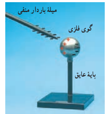
شکل ۱-۳۰ نزدیک کردن میله باردار منفی به گوی فلزی خنثایی که روی پایه عایقی قرار گرفته است، موجب ایجاد بارهای القایی مثبت و منفی در دو طرف گوی فلزی می‌شود.
