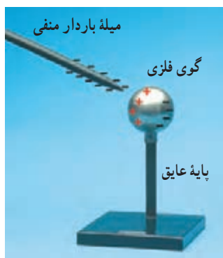
شکل ۲۷-۱ نزدیک کردن میله‌ی بارداری منفی به گوی فلزی خنثایی که روی پایه‌ی عایقی قرار گرفته است، موجب ایجاد بارهای القایی مثبت و منفی در دو طرف گوی فلزی می‌شود.
