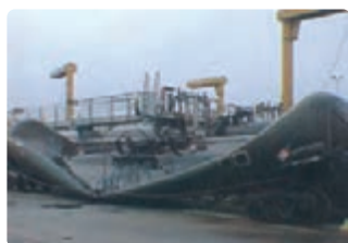
شکل ۴-۳۷ سرد شدن هوای درون مخزن باعث کاهش فشار این هوا و در نتیجه مچاله شدن مخزن شده است.
